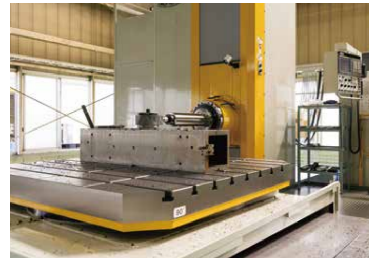
「野村製作所」製 テーブル形横中ぐりフライス盤(2023年7月導入)
